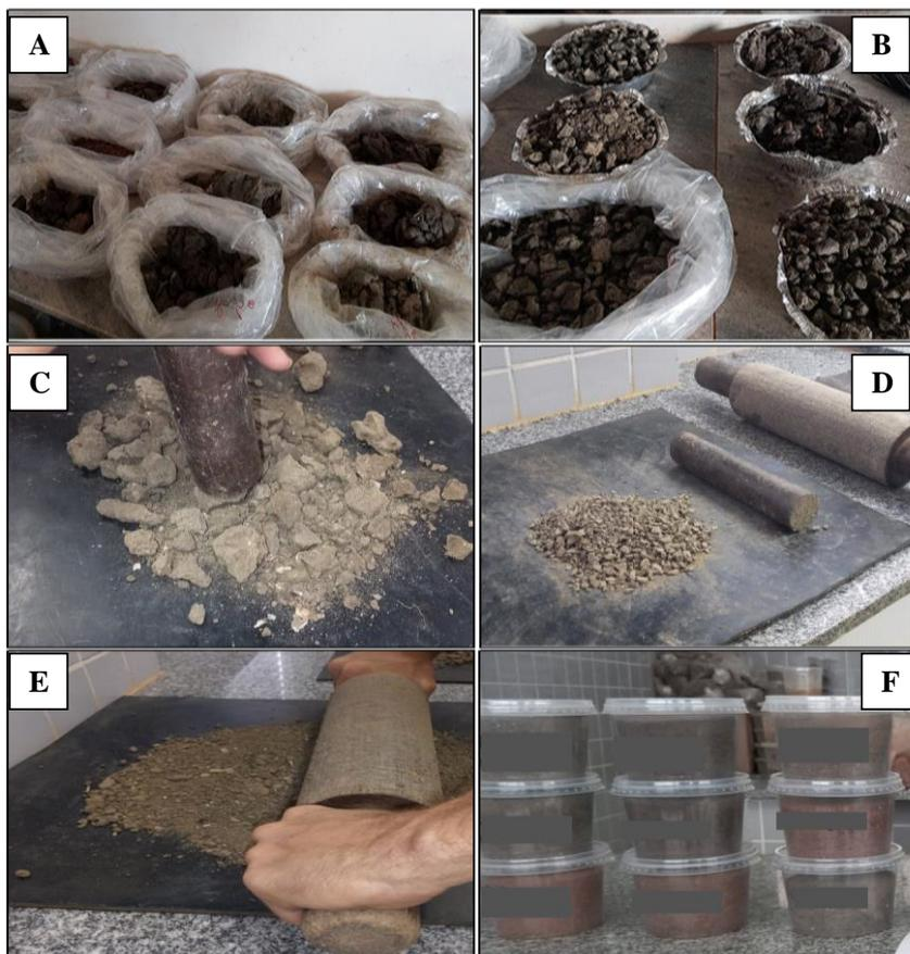
**Figura 5.** A: amostra de solo em sacos plásticos; B: amostras úmidas em bandejas descartáveis de alumínio; C: destorroamento; D: Rolo de madeira. E: Processo de destorroar, com o rolo de madeira. F: armazenamento em potes de plásticos.
