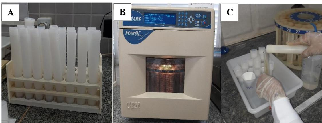
**Figura 10.** A: tubos com as 0,5 g de pó das espécies; B: forno micro-ondas; C: processo de retirada do extrato dos tubos, adição de água deionizada e filtragem.
