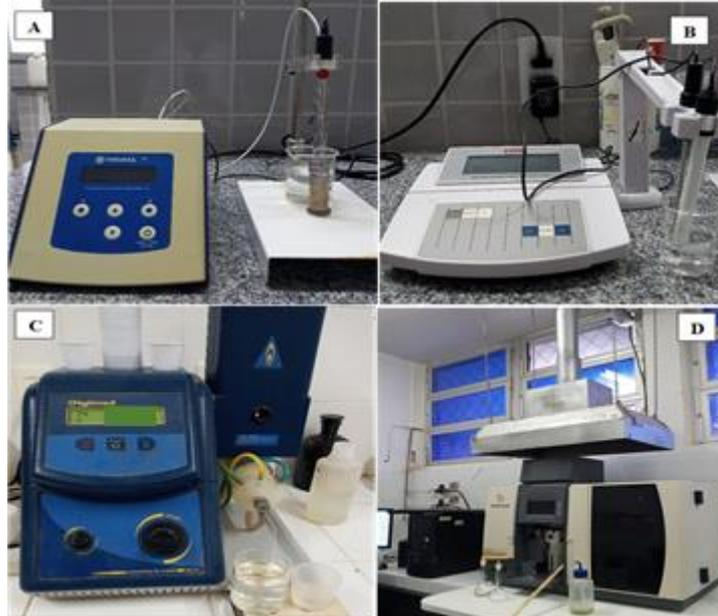
**Figura 7.** A: pHmetro de bancada; B: condutivímetro digital; C: fotômetro de chama; D: Espectrômetro de Absorção Atômica-EAA.
