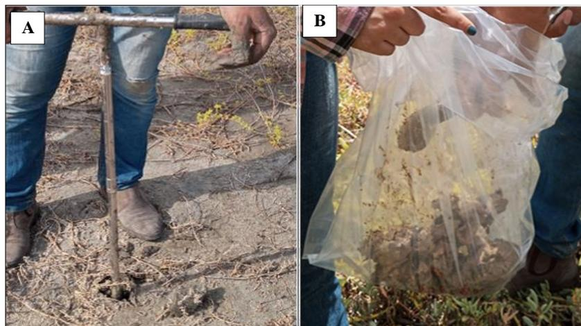
**Figura 4.** **A:** Coleta do solo com o trado holandês; **B:** armazenamento e homogeneização do solo.
