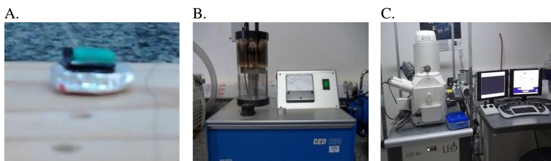
Figura 11. Materiais empregados na análise da bioincrustação, destacando o stub revestido com papel alumínio (A), o evaporador de carbono (B) e o aparelho de microanálise de raios X (C).
