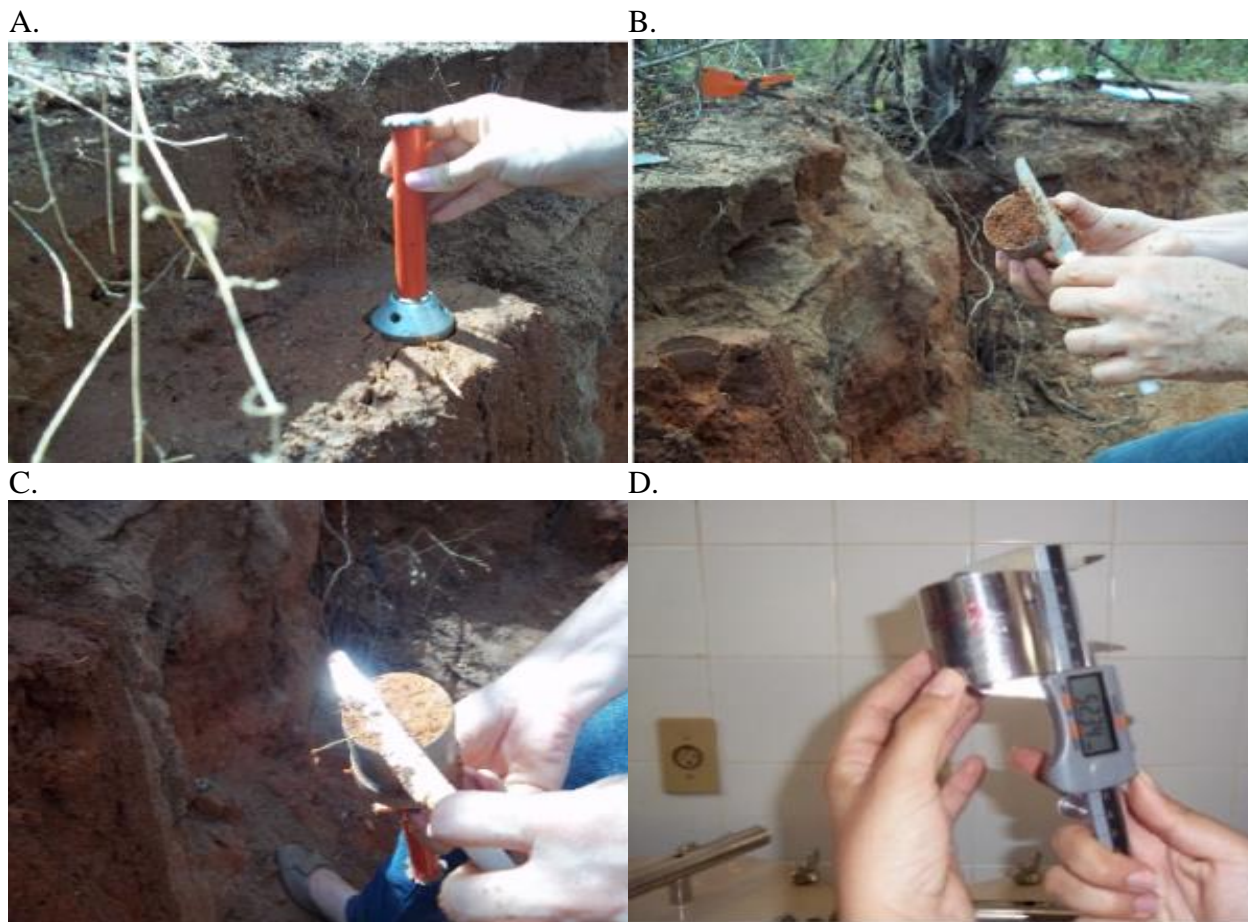
Fonte: Grupo de pesquisa de física do solo, Laboratório de Análise de Solo, Água e Planta (LASAP) - UFERSA Figura 4. Detalhe da coleta (A), beneficiamento das amostras indeformadas (B e C), e medição das dimensões do anel volumétrico (D)
