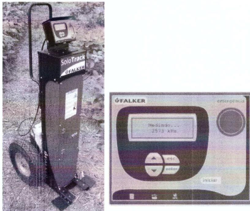
Figura 4 - Penetrômetro de cone SoloTrack da Falker usado para medição da resistência do solo à penetração.
