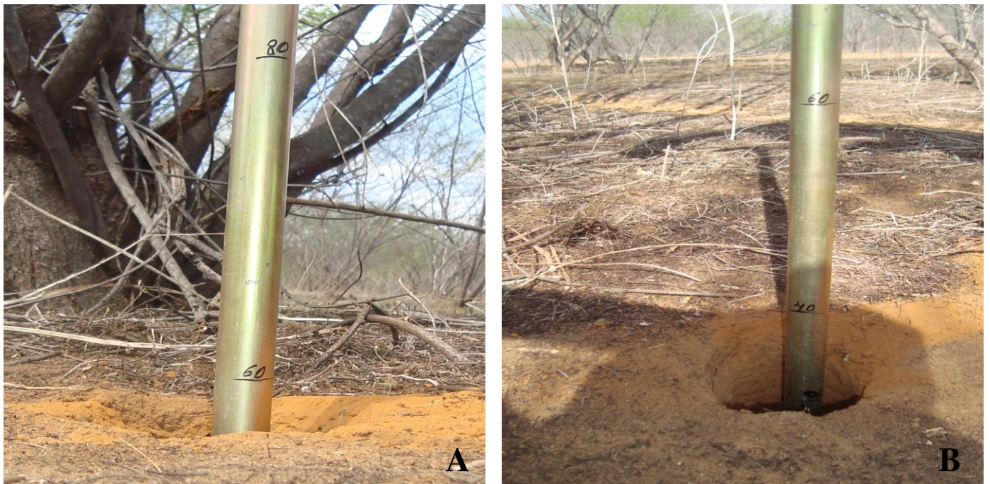
Figura 7. Coleta de amostra de solos, utilizando o trado holandês.
