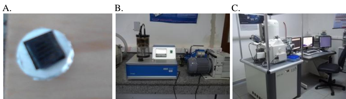
Figura 8. Ilustração dos materiais utilizados na análise da bioincrustação, destacando o stub revestido com papel alumínio (A), o evaporador de carbono (B) e o aparelho de microanálise de raios X (C).
