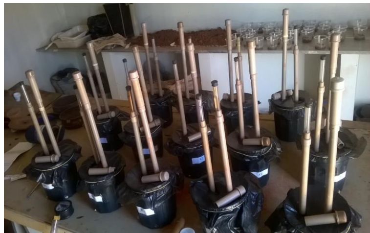
Figura 5 - Teste de fertirrigação para obtenção dos dados da curva de calibração dos nutrientes na solução do solo.
