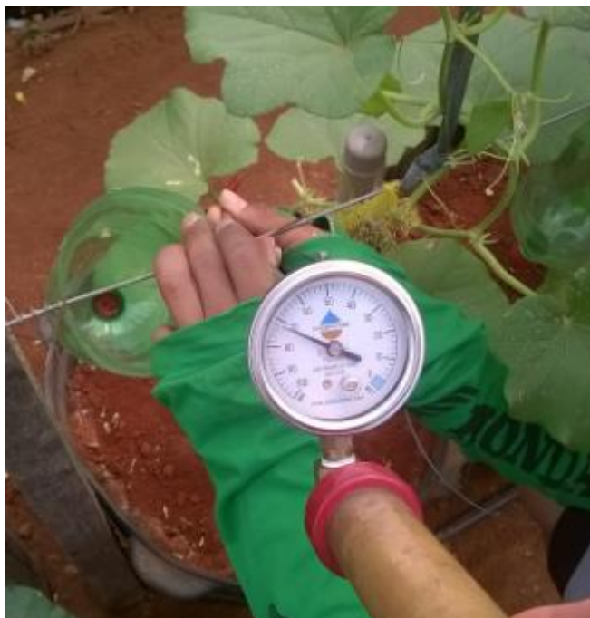
Figura 14 - Aplicação de vácuo nos extratores com auxílio de uma bomba de vácuo.
