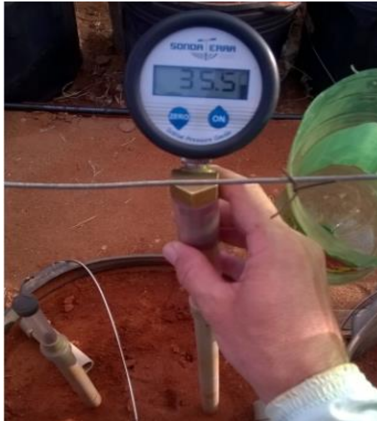
Figura 16 - Monitoramento da umidade do solo com o auxílio do tensímetro.
