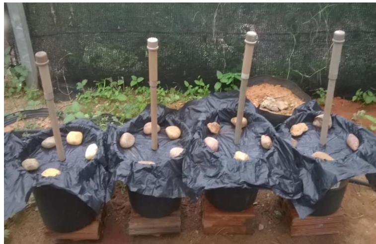
Figura 3 - Vasos com solo umedecido e tensiômetros instalados para obtenção da curva de retenção.
