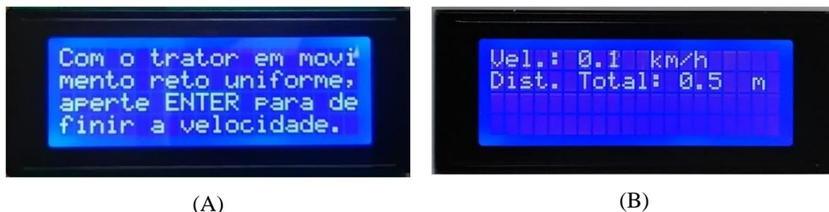
**Figura 28** – Telas da opção “Calibração” (A) tela de instrução (B) tela que exibe os dados de velocidade.
