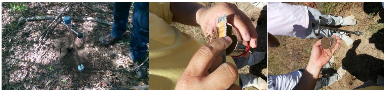
Figura 06. Coleta de solo com estrutura indeformada.
