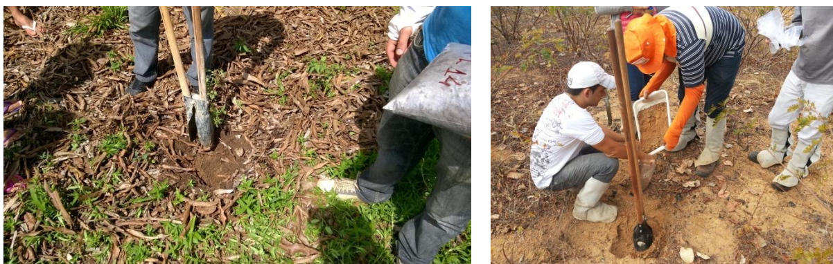
Figura 07: Coleta de solo com estrutura deformada.
