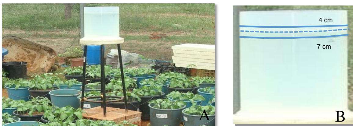
Figura 3 – Tanque evaporímetro posicionado entre as parcelas experimentais (A) e ampliação do tanque com as bordas de leitura (B). UFERSA, Mossoró-RN, 2013
