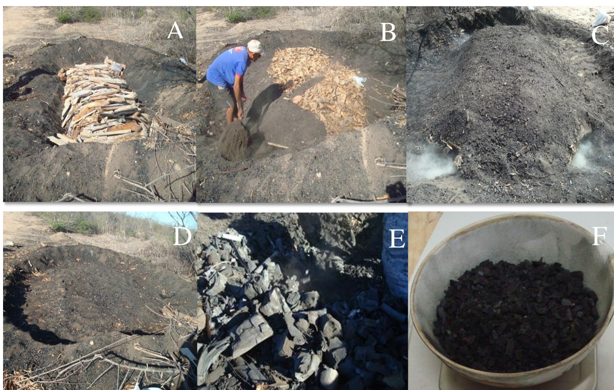
Figura 1 – Preparação do carvão vegetal: forno de terra com os resíduos de poda de cajueiro (A), fechamento do forno (B), processo de carbonização (C), processo de resfriamento do material carbonizado (D), carvão vegetal após carbonização (E) e carvão vegetal triturado e peneirado (F). UFERSA, Mossoró-RN, 2013.
