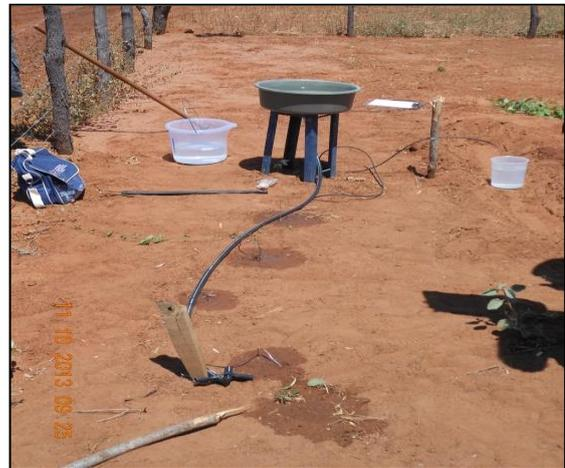
Figura 14 – Imagem do teste realizado para definição da altura da caixa de PVC, da dimensão do sulco e do espagete utilizado no sistema de irrigação no assentamento Milagres em Apodi – RN.
