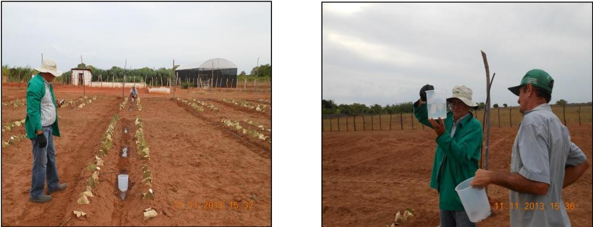
Figura 15 – Teste de vazão do sistema de irrigação utilizado no experimento no assentamento Milagres em Apodi – RN.
