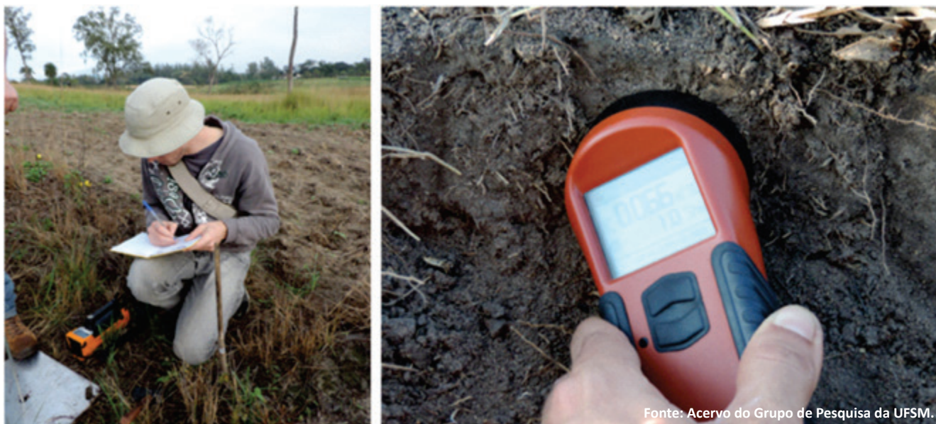
Figura 2. Coleta de dados do solo utilizando sensores proximais (espectrômetro de raios gama à esquerda e medidor de condutividade elétrica e susceptibilidade magnética à direita).
