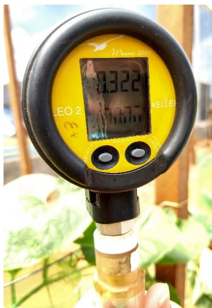
Figura 6. Leitura da tensão na coluna de água. Fonte: Acervo pessoal, 2018.
