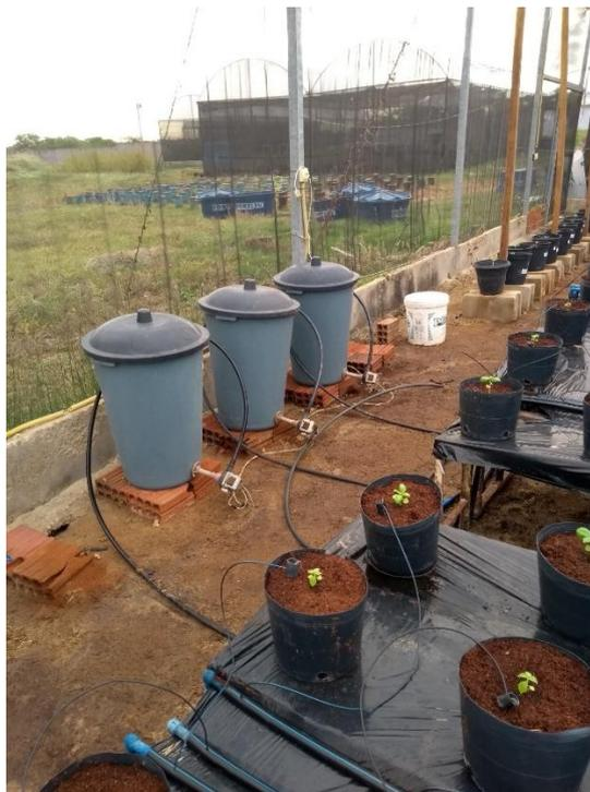
**Figura 5** - Sistema de irrigação do experimento. Mossoró-RN, 2018.
