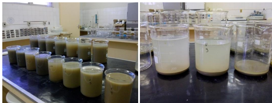
Figura 6. Lavagem dos sedimentos para eliminação de agentes cimentantes.
