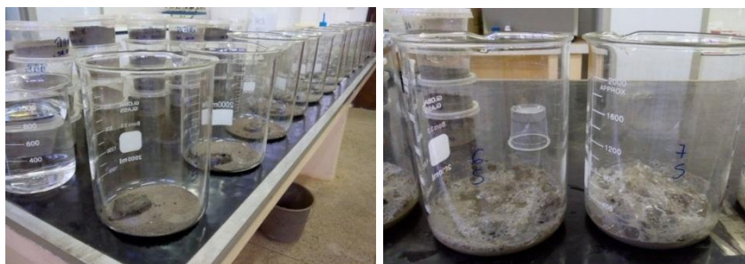
Figura 5. Pré-tratamento dos sedimentos para eliminação de carbonatos, sais e Matéria Orgânica.
