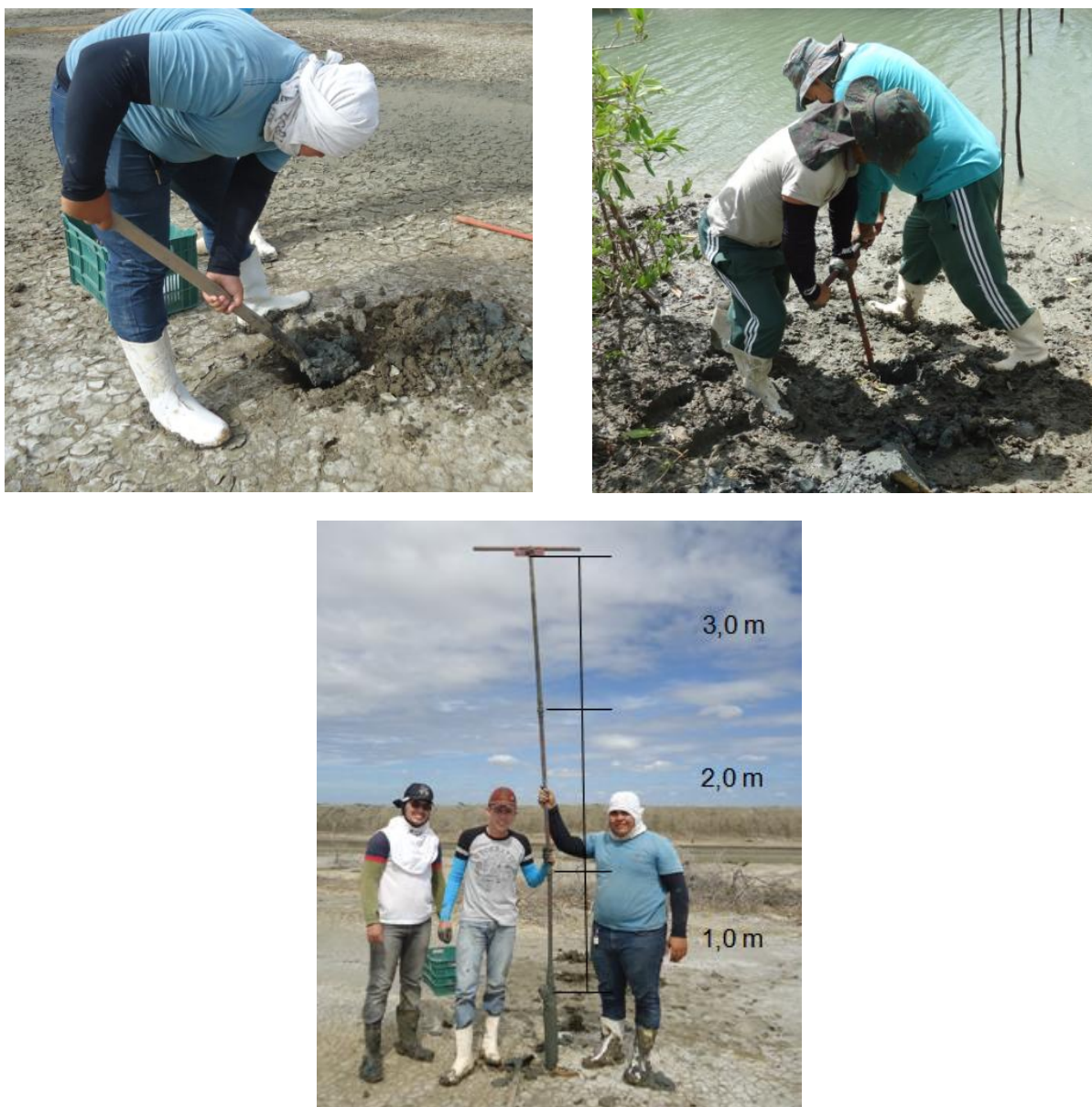
Figura 2. Coleta de solo na profundidade 0.5 e 3.0m, na bacia do Rio Apodi-Mossoró/RN e demonstração do trado utilizado durante as coletas.
