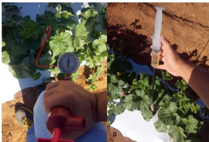
Figura 6 – Aplicação de tensão nos extratores (A) e retirada da solução do solo com auxílio de uma seringa(B).
