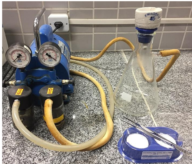
Figura 8. Sistema de filtragem à vácuo utilizado para determinação de sólidos suspensos
