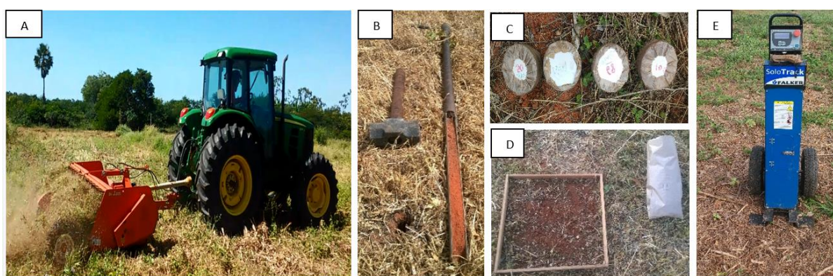
Figura 3. Práticas e equipamento para o manejo da área e coleta de dados: A - Manejo da vegetação com triturador horizontal – triton; B - Trado caneca e marreta para retirada do solo; C - Latas de alumínio para secagem do solo em estufa; D – Quadro de coleta e saco de papel para a cobertura vegetal; E – Penetrômetro automático.
