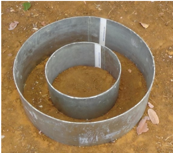
Figura 5. Infiltrômetro da anéis sendo fixado (A) e durante o teste de infiltração de água (B).
