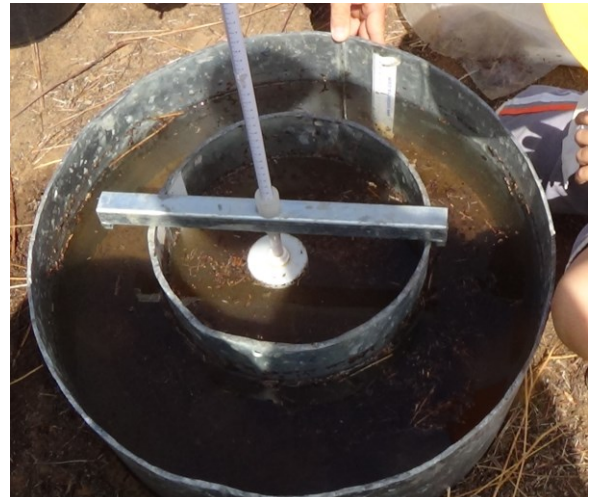
Figura 5. Infiltrômetro da anéis sendo fixado (A) e durante o teste de infiltração de água (B).
