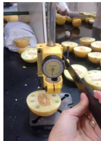
**Figura 10.** Determinação da firmeza de polpa do melão tipo Gália. Mossoró – RN, UFERSA, 2019.
