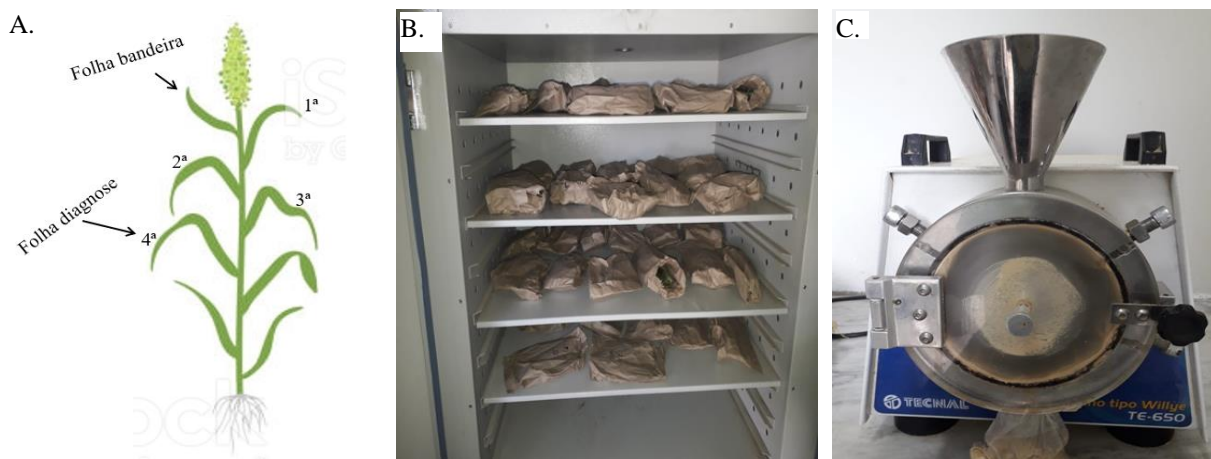
Figura 9. Indicação da quarta folha a partir do ápice para diagnose foliar em Sorgo 8A. Estufa com material vegetal 8B moinho do tipo Willey 8C.
