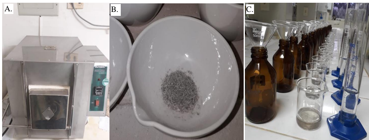
Figura 10. Forno tipo mufla elétrico 10A, Cinzas do material incinerado 10B, Dissolução do material incinerado em ácido nítrico 10C.
